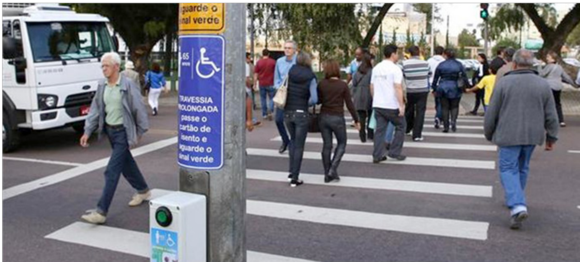
Figura 13.15 - Via de pedestres com sinalização atuada pelo pedestre em Curitiba, PR
